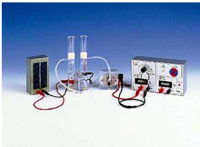
Σχήμα 8.3: Απεικόνιση πειραματικής διάταξης όπου αποτελείται από ηλιακό κύτταρο, ευδιάμετρο, κύτταρο αποθήκευσης καυσίμων-μπαταρία υδρογόνου, αμπερόμετρο-βολτόμετρο
